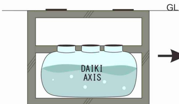
Instalasi bawah tanah lebih dalam
